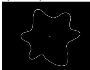
Digital Fabric Properties: [ 0 Drape 0 N 51 AA 36.3 AD 188.41 MP 236.05 MV 136.22 NoP 6 Weight 323 Nom commercial ou coloris Beige Composition laine Epaisseur en mm 1.27 Armure sergé croisé 2 lie 2 Contexture Chaîne / Trame 14,4/17,8 Bending Chaîne 3.546875 Bending Trame 3.091099 Drape Coefficient 0.350291 Nb plis 6.0 CisT 0.327 CisC 0.339 FlexT 0.39 FlexC 0.31 Coloris 0 Motifs 0]
